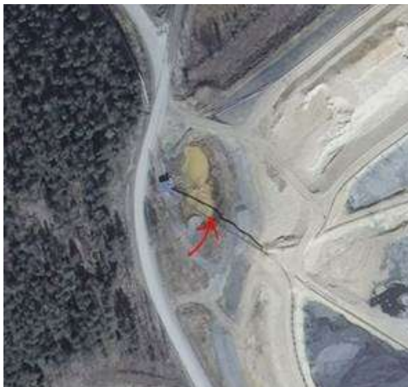
Kuva 14. Vuoto Luikonlahden rikastushiekka-altaan reunalla.
